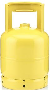
Gasflasche - gelb RAL(1018) - für Schwefeldioxid - konform mit Richtlinie 2010/35/EG T-PED - 7 l - Griff H120 mm - Grundring D.205 mm - Gewinde 17E - Druck 14 bar
