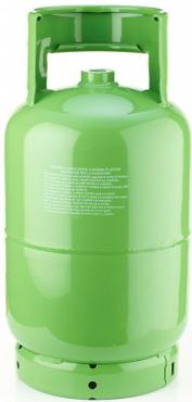
Gasflasche - grün RAL(6018) - für Kältegase Klasse 2A - konform mit Richtlinie 2010/35/EG T-PED - 12,5 l - Griff H120 mm - Grundring D.205 mm - Gewinde 17E / 25E - Drücke 36 / 48 bar
