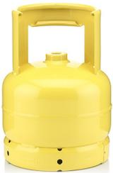
Gasflasche - gelb RAL(1018) - für Schwefeldioxid - konform mit Richtlinie 2010/35/EG T-PED - 4,8 l - Griff H120 mm - Grundring D.205 mm - Gewinde 17E - Druck 14 bar
