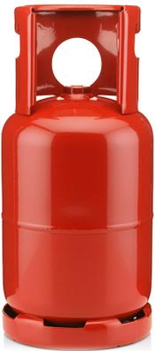
Gasflasche - rot RAL(3000) - für Kältegase Klasse 2F - konform mit Richtlinie 2010/35/EG T-PED - 12,5 l - Griff H158 mm - Grundring D.229 mm - Gewinde 17E / 25E - Druck 48 bar
