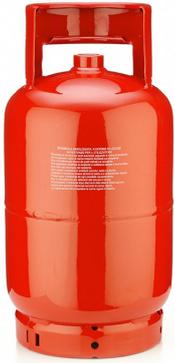
Gasflasche - rot RAL(3000) - für Kältegase Klasse 2F - konform mit Richtlinie 2010/35/EG T-PED - 12,5 l - Griff H120 mm - Grundring D.205 mm - Gewinde 17E / 25E - Drücke 36 / 48 bar
