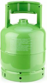
Gasflasche - grün RAL(6018) - für Kältegase Klasse 2A - konform mit Richtlinie 2010/35/EG T-PED - 7 l - Griff H120 mm - Grundring D.205 mm - Gewinde 17E / 25E - Drücke 36 / 48 bar
