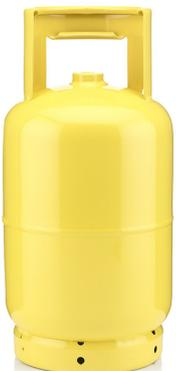
Gasflasche - gelb RAL(1018) - für Schwefeldioxid - konform mit Richtlinie 2010/35/EG T-PED - 12,5 l - Griff H120 mm - Grundring D.205 mm - Gewinde 17E - Druck 14 bar
