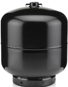
Gasflasche - schwarz - für Kältegase Klasse 2A /2F - konform mit Richtlinie 2014/68/EG T-PED - 22 l - kleiner Griff - Grundring D.205 mm - Gewinde 25E
