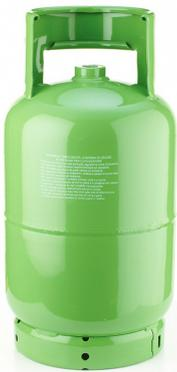
Gasflasche - grün RAL(6018) - für Kältegase Klasse 2A - konform mit Richtlinie 2010/35/EG T-PED - 12 l - Griff H120 mm - Grundring D.205 mm - Gewinde 17E / 25E - Druck 36 bar
